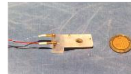
Pequeña celda fabricada con teflón que utiliza el microscopio EQ-STM para contener el electrolito.
