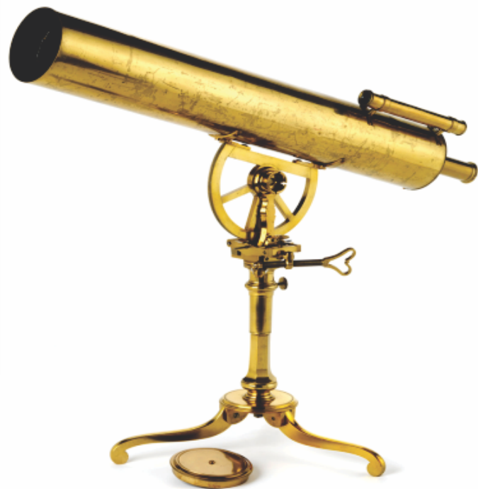
Figura 2. Telescopio reflector Short, como el que utilizó Velázquez.
