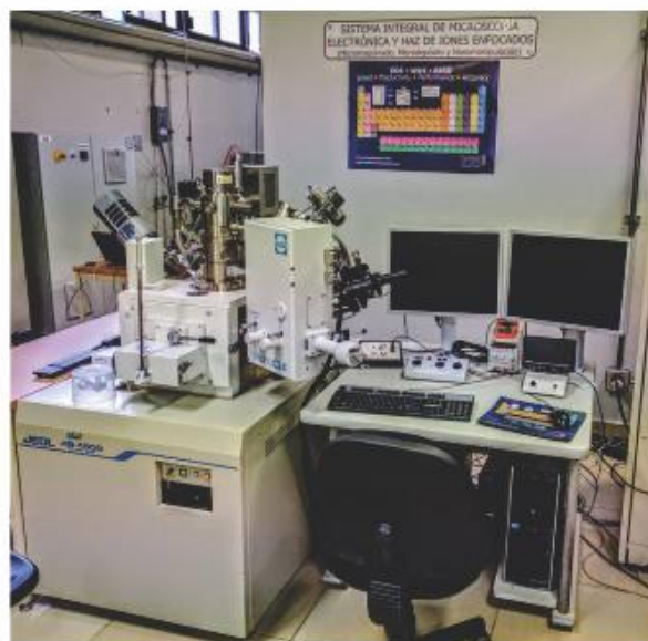
Sistema integral de microscopía Electrónica y haz de iones enfocados (Micromaquinado, microdeposición y nanomanipulación)
