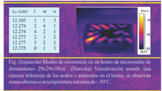
Fig. (Izquierda) Modos de resonancia en un horno de microondas de dimensiones  $29 \times 29 \times 19\text{cm}^3$ . (Derecha) Visualización usando una cámara infrarroja de los nodos y antinodos en el horno, se observan zonas alternas con temperatura máxima de  $\sim 50^\circ\text{C}$ .
