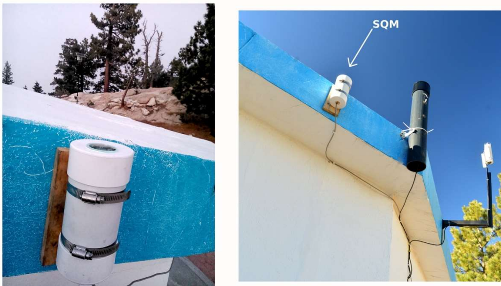
Figura Error! No sequence specified..- Medidor SQM-LE (izquierda) y su ubicación al exterior del edificio del telescopio de 1.5m (derecha).
