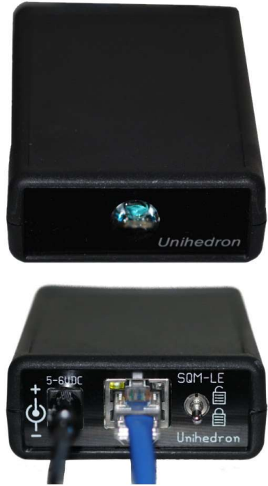
Figura 2.- Medidor de brillo del cielo SQM-LE.
